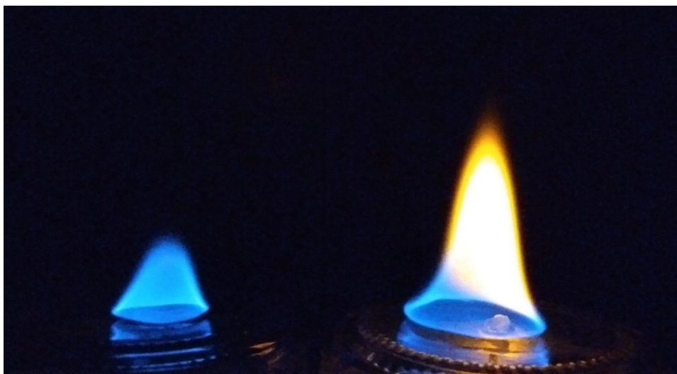
Kuva 8. Etanoliliekin väri ja liekkireaktio pimeässä huoneessa. Vasen liekki on 70 % etanoliliuos ja oikea liekki on värjätty NaCl-kiteellä saman vahvuudessa etanoliliuoksessa.
