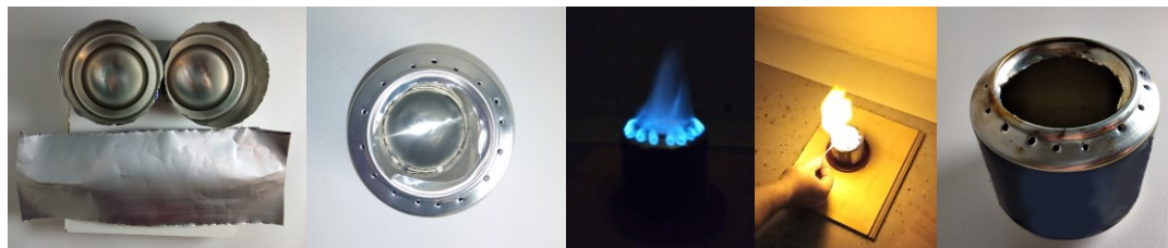
Kuva 9. Itsetehty etanolipoltin kolmesta 330 ml:n alumiinitölkistä. Vasemmalta oikealle: polttimen osat, poltin kasattuna, sytytetty poltin (70 % etanoliliuos), NaCl-liuoksessa kastettu vanupuikko polttimen liekissä ja poltin käytön jälkeen. 30
