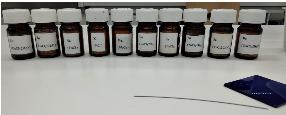
Kuva 1. Itä-Suomen yliopiston kemian laitoksen TopLab -opetuslaboratorion kvalitatiivisen analyysin vertailussa käytettäviä liekkikoesuoloja, nikkeli-kromilanka ja tunnistamisen apuna käytettävä koboltilasi.
