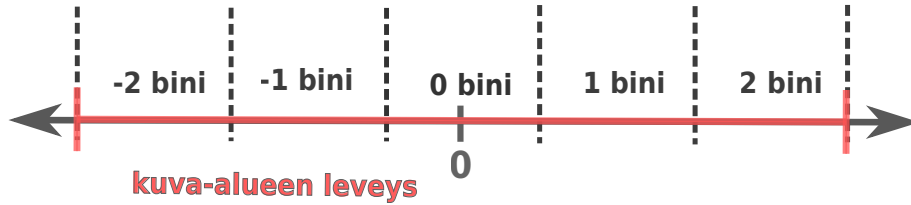
Kuva 6: TOF-binit ja niiden numerointi, kun binien määrä on viisi ja valittu vastesuora on kuva-alueen levyinen. Punaisella on merkitty kuva-alueen leveys. Lisäksi nollabinin keskelle on merkitty vastesuoran nollakohta.
