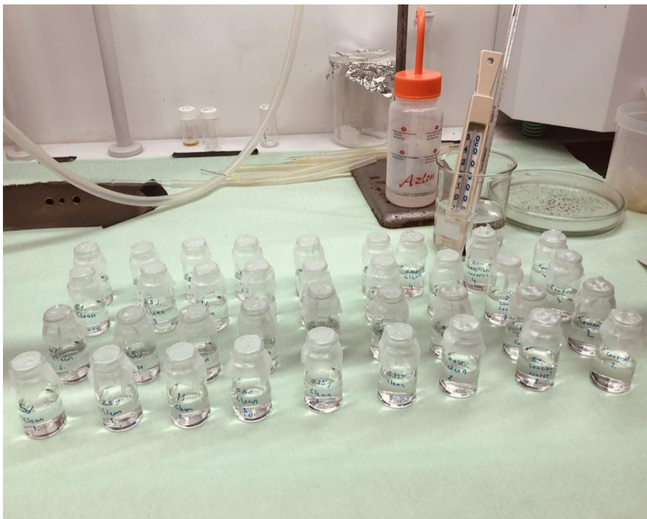
Kuva 11. Ei poltettujen filttorien suotovesitestit. Pikkupullot päällystettiin parafilmillä, johon tehtiin neljä reikää ilmanvaihtoa varten ja veden haihtumisen minimoimiseksi.
