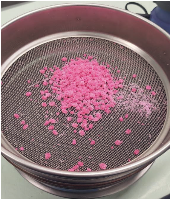
Kuva 8. Jauhettujen mikromuovien erotteluun käytettiin 500 \mu\text{m} :n ja 300 \mu\text{m} :n seuloja.
