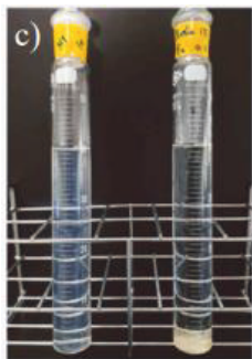
Kuva 50. Vasemmalla koeputkessa PS-nanopartikkeliuos (10 mg/l) ennen FeCl 3 :n ja pektiinin lisäystä ja oikealle 72 h sen jälkeen. Oikealla on esitetty PS:n poistoprosentit ajan funktiona. (Moriwaki et al. 2022)
