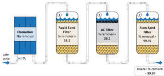
Kuva 51. Nanopartikkeleiden poistaminen tyyppillisessä juomivedenkäsittelyprosessissa (Pulido-Reyes et al. 2022)
