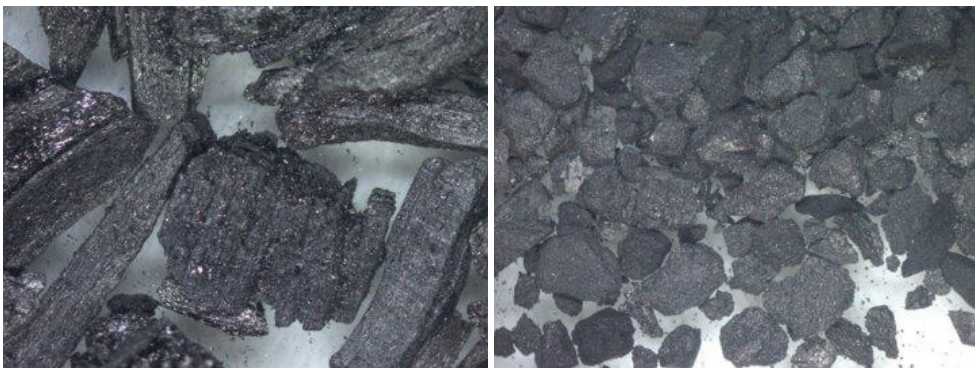
Kuva 9. Suodatuskokeissa testattua biohiiltä (vasemmalla) ja aktiivihieltä (oikealla). Valomikroskooppikuvien leveys 11 mm.
