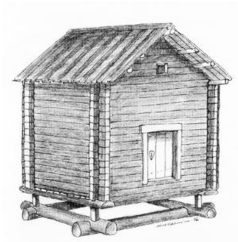
Kuva 1. Entisaikainen "pilariperustus". Alimmat, maassa makaavat hirret uusittiin aika-ajoin. Pohjois- ja Länsi Suomessa harrastettiin paljon tämän kaltaisia jalallisia aittoja. Kapeiden tolppien päällä ns. hiirilaudat, jotka estivät hirten päästyn aittaan (Kolehmainen 1997).
