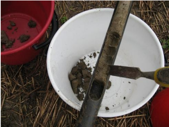
Kuva 3. Syvämaanäytteiden ottaminen kairalla (kuva Tiina Tontti)
