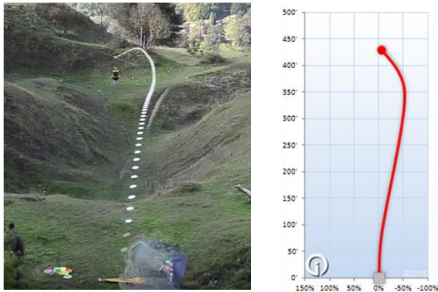
Kuva 2.1 Tyypillinen kiekon lentorata heitettäessä oikeankäden rystyheittoa a) videolla [4] b) simuloitu lentorata ylhäältäpäin. [5]
