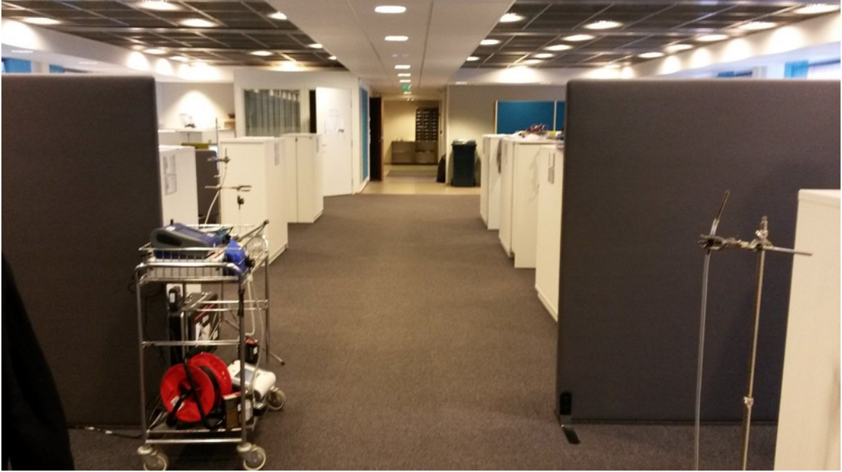
Kuva 3. Näytteenottotilanne kohteen 1 2. kerroksen etummaisesta osasta. Kuvassa vasemmalla on IOM-hiukkaskeräin ja optiset hiukkasmittarit kärryssä ja IOM-hiukkaskeräin ja VOC-keräin telineessä kärryn takana sekä oikealla VOC-keräin telineessä.
