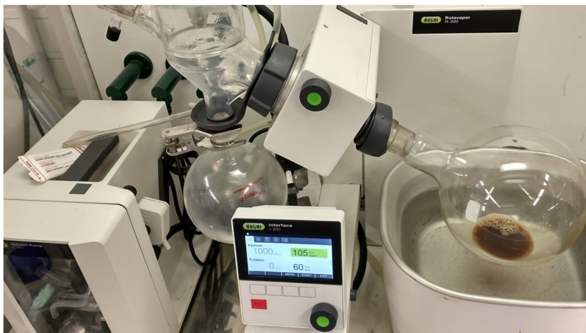
Kuva 18. Rotavapor-laite. Oikealla olevassa kolvissa lämmitettiin vesihauteessa näytettä, josta haihtuneet kaasut kondensoitiin keskellä olevaan kolviin.
