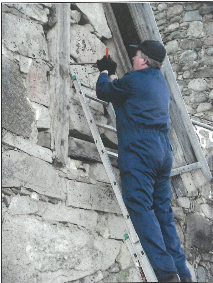
Kuva 3. Ajoitusnäytettä F4H4003 kairataan sakariston pohjoispäädystä.
