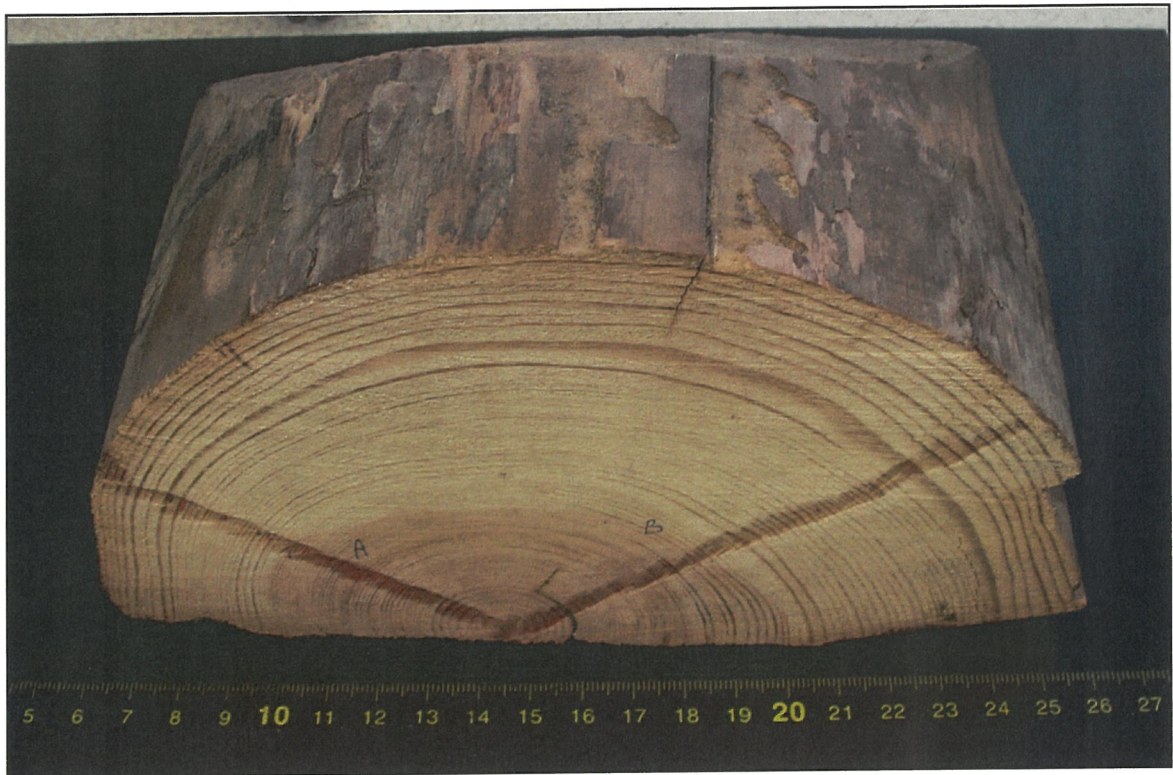
Liitekuva 3. Säamingin kellotapulien rakennustellinkien ajoitusnäyte FIM3004, vanha lattialankku.
