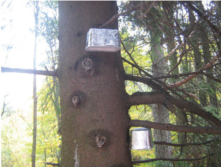
Kuva 6. Ulkoilmamittauksessa loggerit on sijoitettu suojaisaan paikkaan puun alle. Loggerit on kiinnitetty alumiiniteipillä päällystettyjen pakasterasioiden sisälle ja näin ne on suojattu sekä sateelta että auringonpaisteelta.
