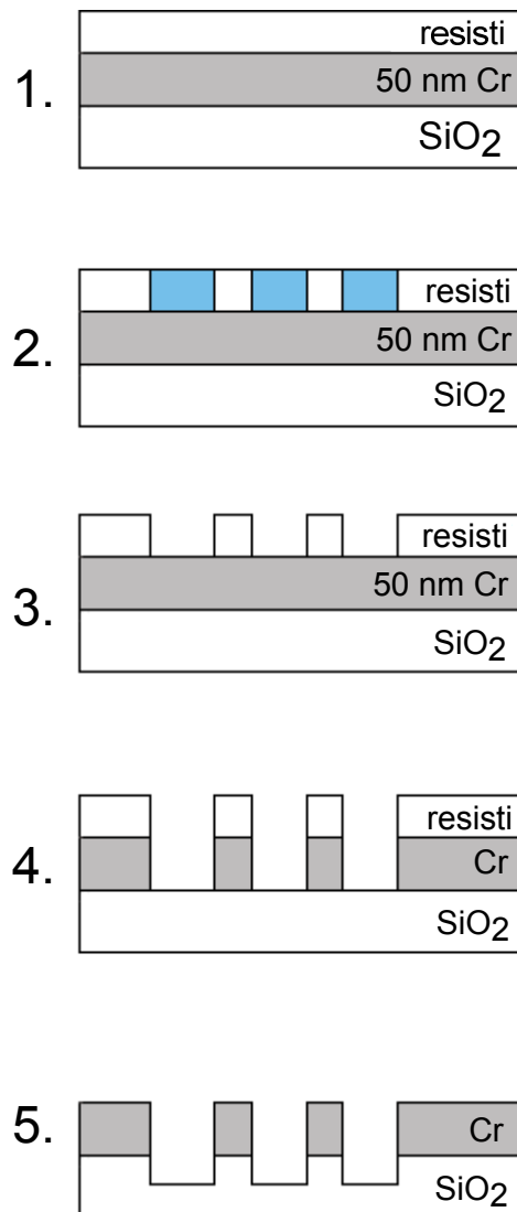
Kuva 4.1: Näytteiden valmistusprosessin kulku. 1. \text{SiO}_2 -kiekko päällystettiin kromilla, jonka päälle levitettiin positiivinen resisti. 2. Resistiin valotettiin hilarakenteet elektronisuihkulla. 3. Resisti kehitettiin, jolloin valotetut alueet liukenivat. 4. Liunneen resistin alta paljastunut kromi etsattiin Plasmalab 100 –laitteistolla. 5. Kromin alta paljastuneet \text{SiO}_2 -substraatin alueet etsattiin Plasmalab 80 –laitteistolla.
